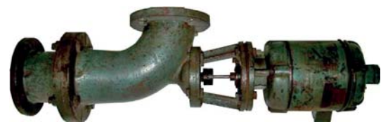
Eerste verwarmingscirculatiepomp Krümmerpumpe, bouwjaar 1929, HP type DN 67/0,25 kW
