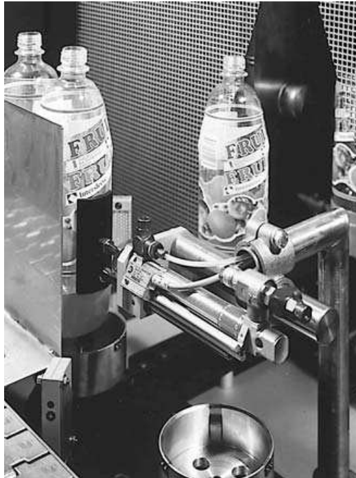
Figuur 0.2 Toepassing reed-schakelaars op een cilinder
